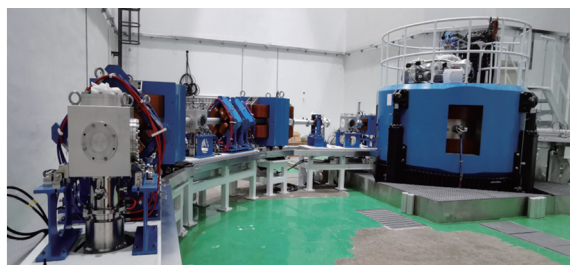
图 2 50 MeV 回旋加速器及其束流传输线
